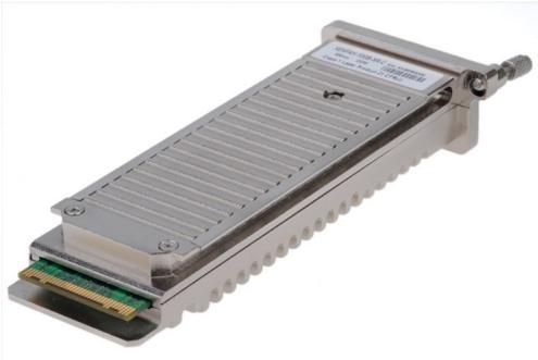
Xenpak, definiert von MSA (multi-source agreement) wurde offiziell im März 2001 vorgestellt. Die optische Transceiver Gruppe entspricht dem 10 Gigabit Ethernet (10GbE) Standard der Institute of Electrical and Electronics Engineers (IEEE) 802.3 working group.
